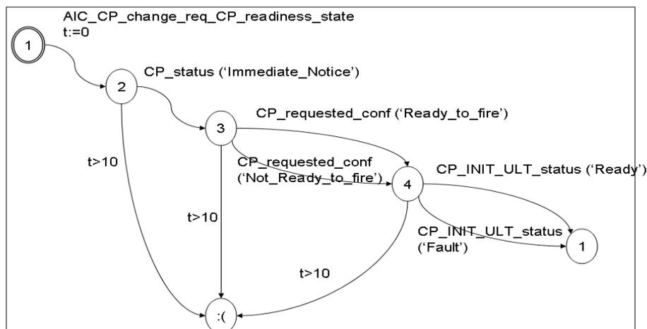
**Figure 6 :** Automate observateur de la propriété *REQ\_S\_CP\_SUPSTATE\_0320*
