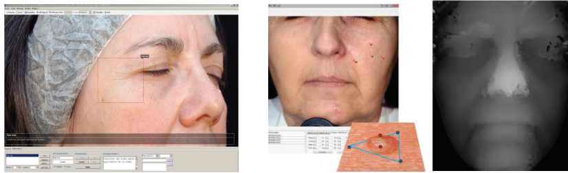
FIG. 2 – Annotation, mesure 3D et carte de profondeur calculée sur 0.1 % des pixels.
