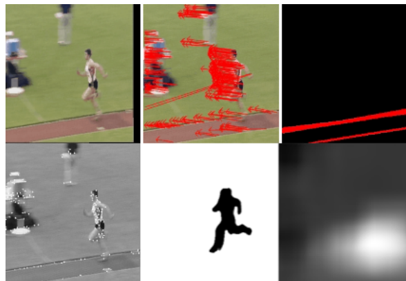
FIG. 2 – Exemple de primitives extraites : image compensée, flot optique, lignes caractéristiques, puis sur la seconde ligne, points d'intérêt spatio-temporels, masque des objets en mouvement et histogramme HLS.
