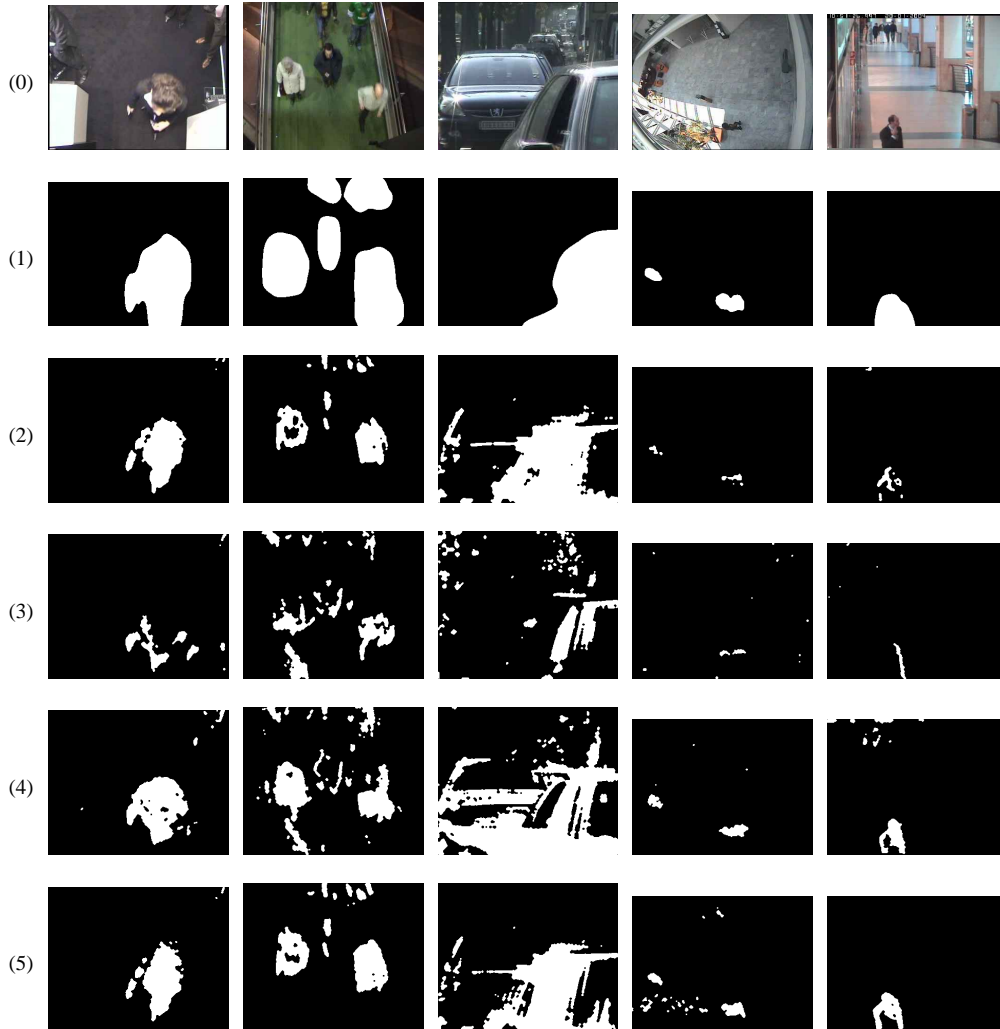
FIG. 7 – Résultats obtenus sur 5 séquences avec 5 algorithmes : (1) notre algorithme, (2) dérivée temporelle lissée, (3) modélisation gaussienne, (4) modélisation non paramétrique, (5) entropie spatio-temporelle.
