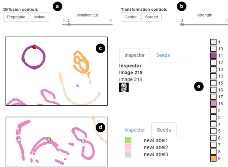
FIG. 2 – a) Contrôles de diffusion d’étiquettes. b) Contrôles de modification des dissimilarités. c) Le survol des éléments déclenche un inspecteur interactif. Les éléments hors de la restriction en cours sont affichés en transparence. d) Les pivots sélectionnés sont listés dans un panneau éditable. e) Le contrôle de la restriction se fait par une légende cliquable.
