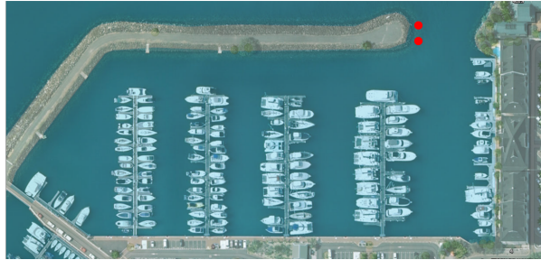
FIG. 4 – Vue aérienne du Port Brunelet. Les points rouges représentent la position des hydrophones
